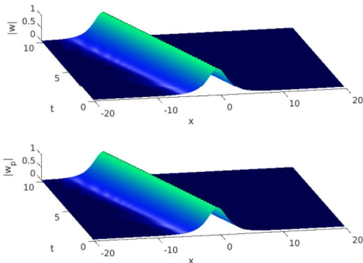
**Figura:** Amplitudes de entrenamiento  $|w(t)|$  (arriba). Predicciones  $|w_p(t)|$  calculadas con ATC para  $\text{drk}_\delta(\Sigma_T) = 0$  (abajo).
