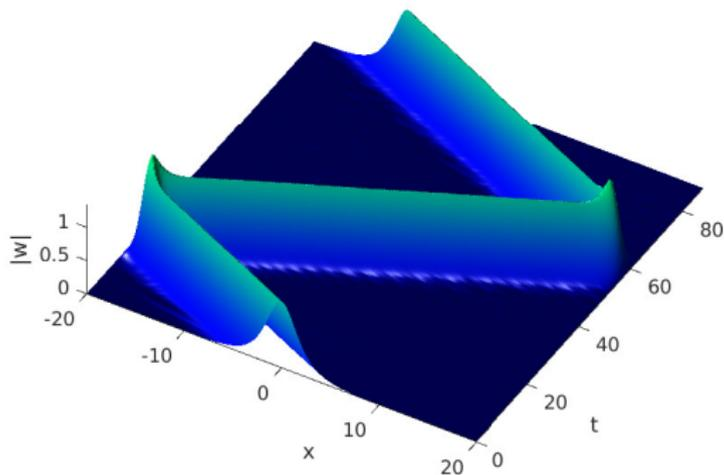
**Figura:** Historial de evolución de amplitudes de solución de onda viajera para el modelo no lineal:  $i\partial_t w + \partial_x^2 w + q|w|^2 w = 0$ .
